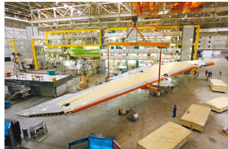
복합재료가 된 항공기 날개, 다이아몬드 코팅 공구를 사용한 리벳 구멍의 드릴링과 리밍
